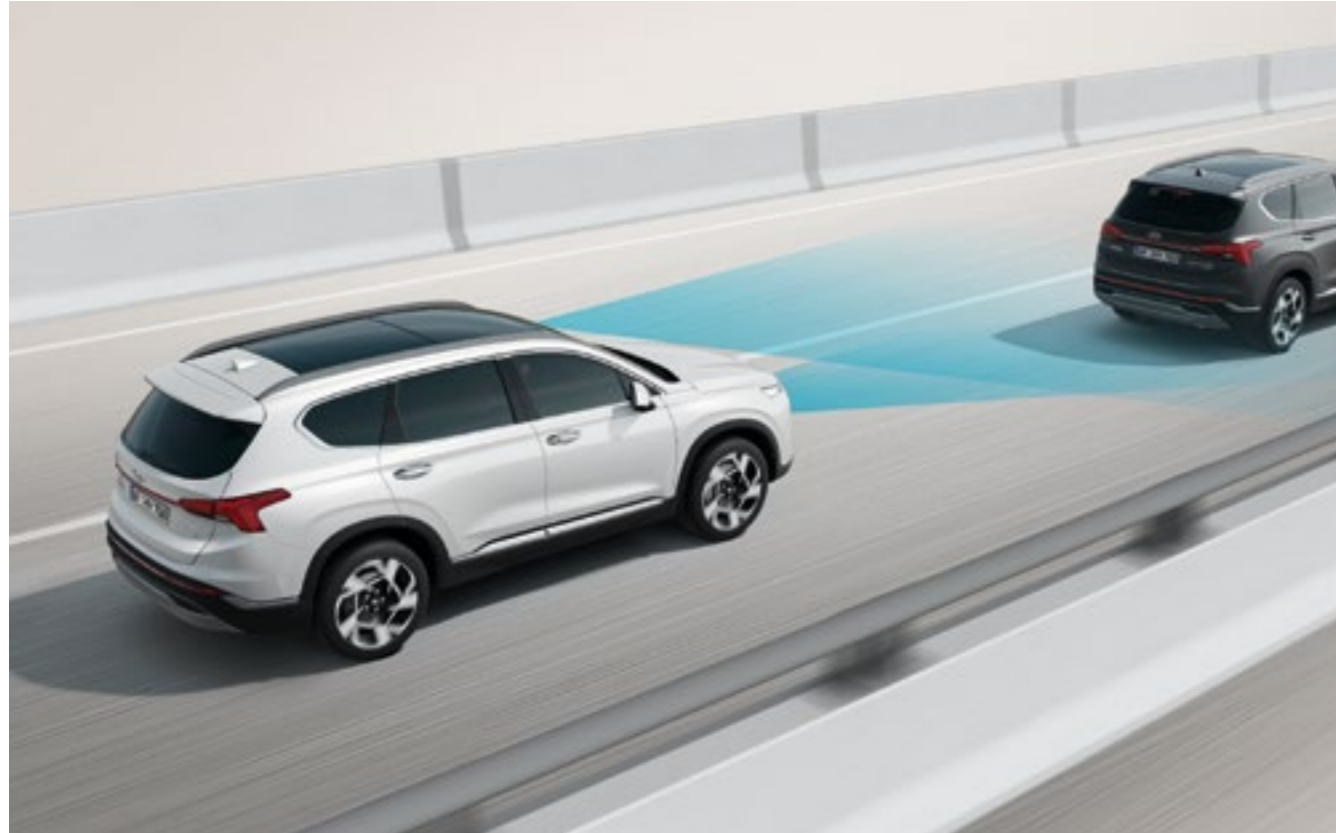
Pomoć u vožnji autocestom (Highway Driving Assist - HDA) Omogućuje vam da budete centrirani u svom traku i da putujete na sigurnoj udaljenosti iza automobila ispred sebe ako su aktivni Pametni tempomat ili Pomoć za praćenje prometnih traka.
