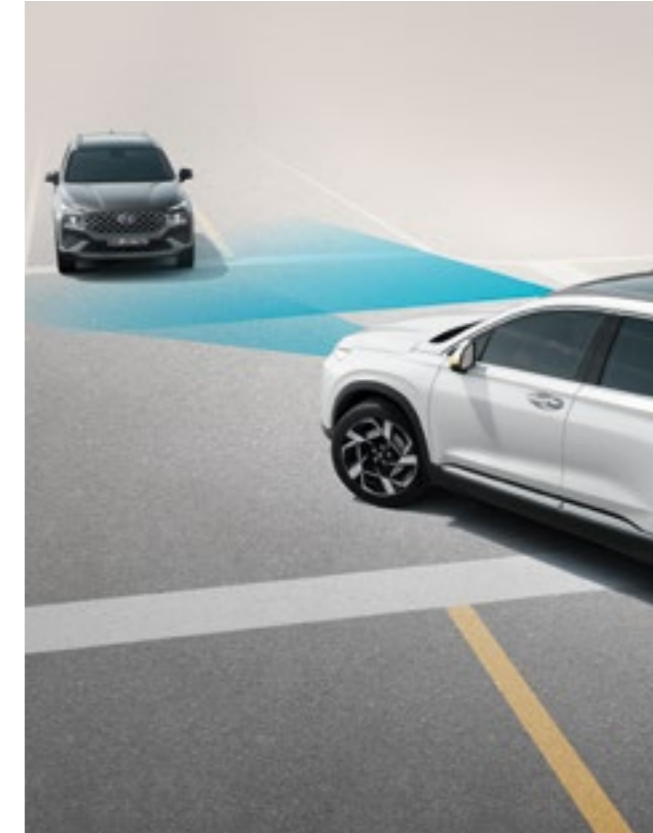
Pomoć za izbjegavanje frontalnog sudara, skretanje na raskrižju (Forward Collision-Avoidance Assist - FCA, junction turning) FCA sustav vas upozorava i automatski koči ako otkrije naglo kočenje vozila ispred vašega ili pješake i bicikle na cesti. Isto vrijedi i za rizik sudara s nadolazećim vozilima tijekom skretanja ulijevo na raskrižju.
