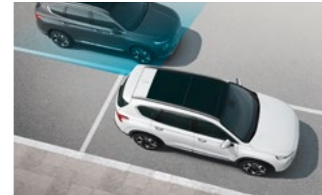
Pomoć pri izbjegavanju sudara u mrtvom kutu (Blind Spot Collision-Avoidance Assist - BCA) Korištenjem radarskih senzora u donjem dijelu stražnjeg branika i prednje kamere, sustav vas upozorava na promet u području mrtvog kuta. Ako u takvoj situaciji uključite pokazivač smjera, sustav će se oglasiti zvučnim upozorenjem i zakočiti kako bi se spriječio sudar.
