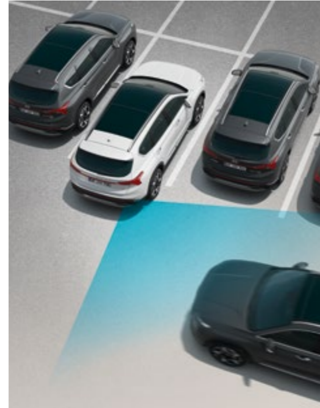
Pomoć pri izbjegavanju bočnog sudara pri vožnji unatrag (Rear Cross-traffic Collision-Avoidance Assist - RCCA) Kad izlazite unatrag s područja sa slabom vidljivošću sustav ne samo da upozorava vozača ako vozila prilaze sa strane - već automatski aktivira i kočnice.
