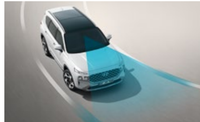
Navigacijski pametni tempomat (Navigation-based Smart Cruise Control - NSCC) Koristi vrhunski navigacijski sustav za predviđanje nadolazećih zavoja ili ravnina na autocestama i prilagođava brzinu radi sigurnije vožnje.
